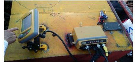
치를 지정하면 바지선이 해당 구역 작업 후 측량선이 다시 확인해야 합니다. 만약 파도에 의한 바지선 위치 변동이 있을 경우 바지선의 위치를 조정한 후 재 작업을 해야 했으나 이번 3D MC GPS 시스템 도입으로 위치 변동을 바로 확인 하면서 작업을 할 수 있게 되었다며 작업의 효율성이 높아지고 작업 인원 배치와 업무 배분까지 가능한 작업 환경이 되었다고 합니다.
