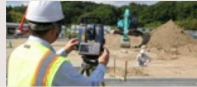
**자동추적 기능** 자동시준을 통해 프리즘을 잡은 후에는 프리즘이 움직여도 항상 추적을 합니다. 만일 추적 중에 놓쳐도 원격 컨트롤 시스템이나 하이브리드 서베이 시스템 등으로 간단하게 재추적할 수 있습니다.
