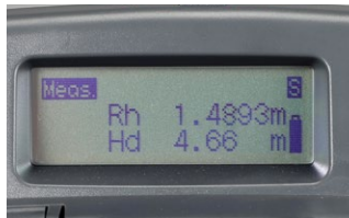
DL-500의 경우 스타프 코드를 자동적으로 해독하여 정확한 측정치를 그 즉시 디지털 표시
