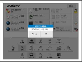
[ システム ]-[GPS]-[詳細設定]を選択し、 「NVRAM のリセット」を選択します。
