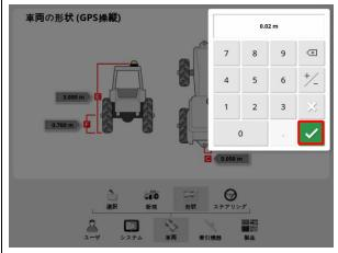
アンテナ位置の中心からのズレ量を入力(左図は 2 cm ズレている場合)し、✓ を押して完了です。
