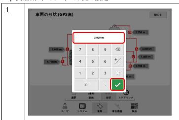
[車両]→[形状]で車両の形状を入力する画面を開き、 E:受信機の高さを選択します。
