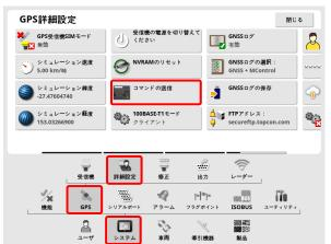
[ システム ]-[GPS]-[詳細設定]を選択し、「コマンドの送信」を選択します。
