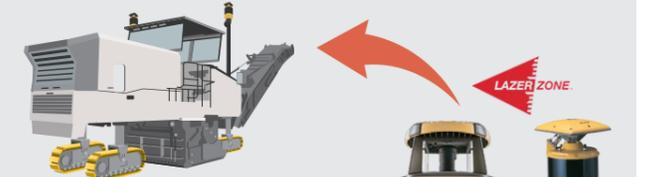
レーザー1台でMC、測量の複数作業が可能！
