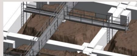
根伐工事直後に、BIMと計測データで足場設置をシミュレーション。計画の前倒しと部材調達最適化を実現。
