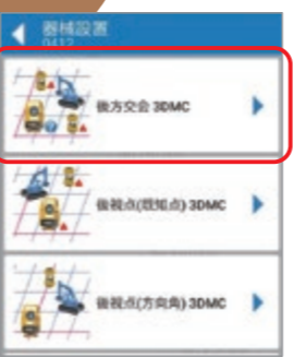
杭ナビショベルの器械設置に対応 『監督さん3D』で杭ナビショベルの器械設置した情報(トプコンMC/MG施工データフォーマット)を、ショベルガイダンスで共有でき、効率的な現場運用が行えます。
