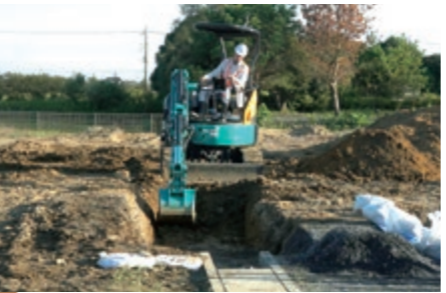
スイングブームに対応 (オプション) センサーを所定の位置に装着することで、狭小現場での運用や構造物付近での掘削作業で、スムーズな作業が可能となります。
