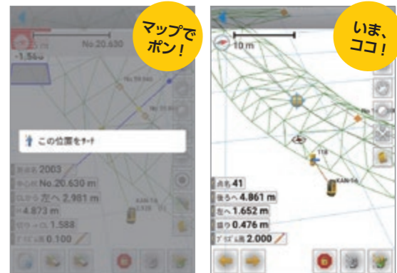
3Dマップビュー マップ画面でリアルタイムに自分の位置がわかるから、杭ナビを任意の方向に振り向かせたり、行きたいポイントに移動することが可能です。
