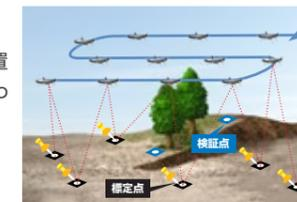
TSトラッキングUASによる UAV 測量イメージ
