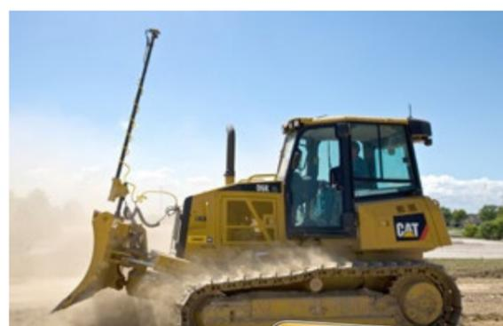
高速高精度マシンコントロールシステム
