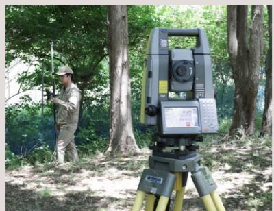
高効率性、静音性、長寿命などの特長を持つブラシレス DC モーター (BLDC モーター) を測量機用に新開発するとともに、独自の制御技術を採用した「Silky Drive®」。これまで以上に迅速で効率的な測量作業を可能にしています。
